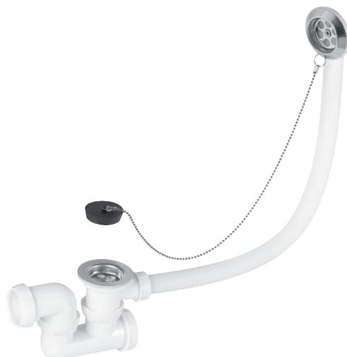
Vidage complet WIRQUIN pour équiper les baignoires, incluant une bonde, un trop-plein et un siphon orientable avec garde d'eau de 50 mm efficace contre les remontées d'odeurs.
